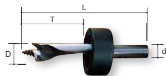
■こま用 ●規格 サイズ=D、全長=L、溝長・有効長=T、チャック径=d
