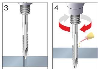
4 加工物に切削油をつけてインパクトドライバーをスロー回転させながら、ネジ立て作業を行います。
